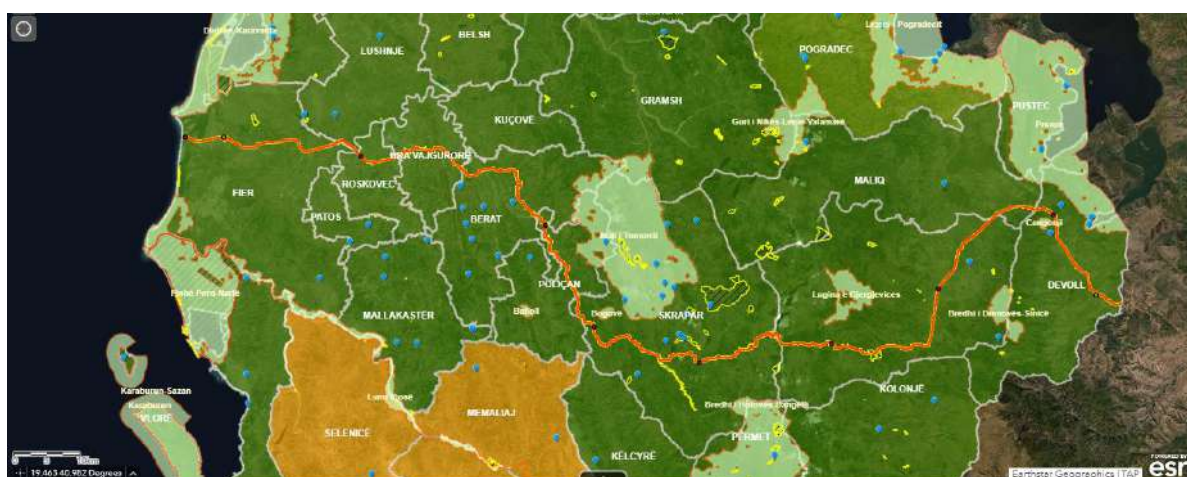
Figura 38. Gjurma e gazsjellësit TAP në territorin Shqiptar, përfshirë 9 stacione valvulash bllokimi, 1 stacion valula dalje, një stacion matje, si dhe një stacion kompresorësh. (Burimi: e-Planifikimi (arcgis.com))
